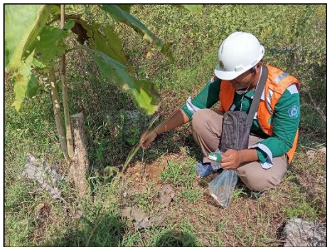
Pengukuran Parameter Kualitas Tanah dan Pengambilan Sampel
