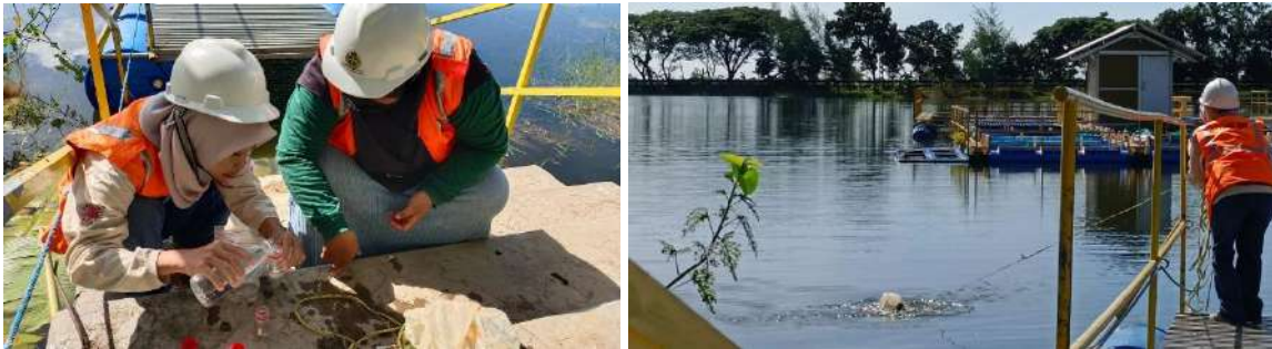
Gambar 11 Pengambilan Sampel Plankton Dengan Teknik Lempar Menggunakan Small Standar Plankton Net Di Tlogowaru (TLO) Pada Mei 2025 [Sumber: Dokumentasi Kegiatan]
